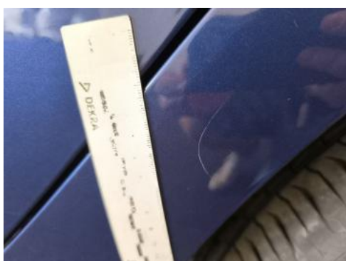
Fot. 51 Błotnik tylny L / Ściana boczna L - Rysa/odprysk 2
