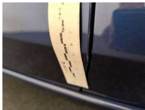
Fot. 42 Drzwi tylne P - Rysa/odprysk 1
