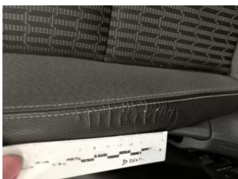
Fot. 59 Fotel prz. lew. - Pęknięcie/rozerwanie 1
