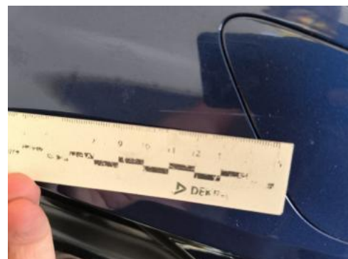
Fot. 38 Zderzak() - Rysa/odprysk 3
