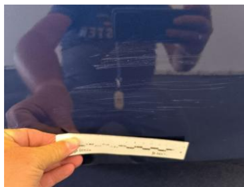
Fot. 48 Zderzak tylny() - Rysa/odprysk 3
