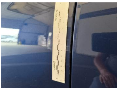
Fot. 53 Drzwi przed L - Rysa/odprysk 1
