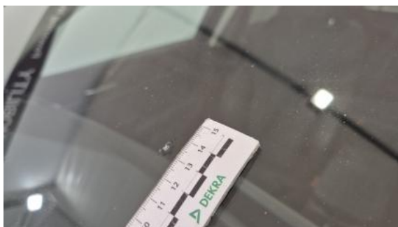
Fot. 37 Szyba czołowa - Pęknięcie/rozerwanie 1
