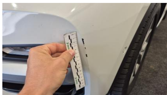
Fot. 40 Zderzak() - Rysa/odprysk 3
