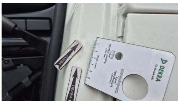
Fot. 67 Słupek środkowy L - Wgniecenie/odkształcenie 1
