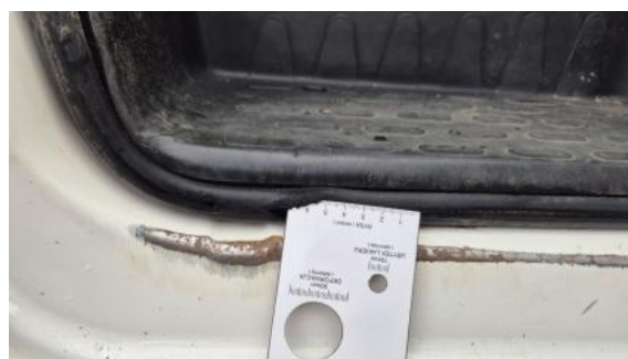
Fot. 72 Uszczelka drzwi przednich P - Pęknięcie/rozerwanie 1
