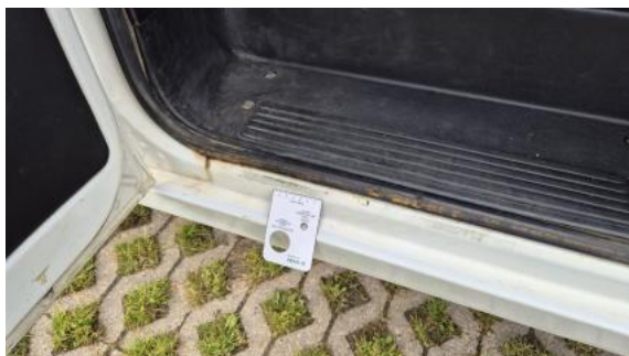
Fot. 65 Próg L - Rysa/odprysk 1
