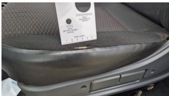
Fot. 69 Fotel prz. lew. - Pęknięcie/rozerwanie 1
