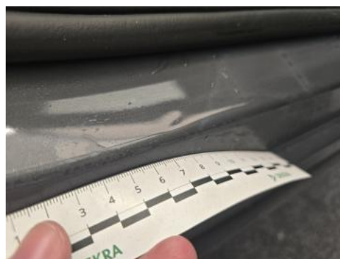
Fot. 44 Próg P - Wgniecenie/odkształcenie 1
