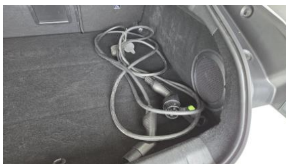
Fot. 28 Przewód ładowania baterii trakcyjnej
