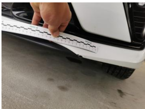
Fot. 41 Zderzak - Rysa/odprysk 2
