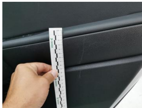
Fot. 50 Tapicerka drzwi tylnych P - Rysa/odprysk 1
