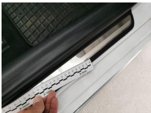
Fot. 45 Próg P - Wgniecenie/odkształcenie 1
