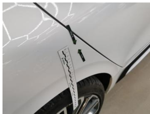
Fot. 46 Błotnik tylny P / Ściana boczna P - Wgniecenie/odkształcenie 1
