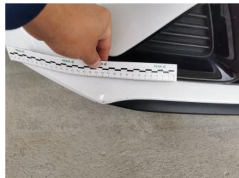
Fot. 40 Zderzak - Rysa/odprysk 1
