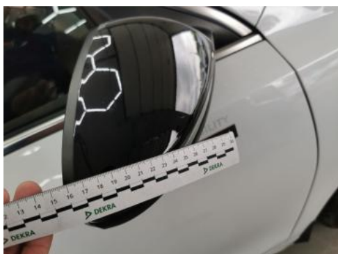
Fot. 43 Lusterko zew P - Rysa/odprysk 1
