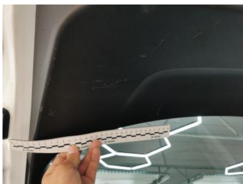
Fot. 51 Wykładzina pokrywy tylnej - Rysa/odprysk 1
