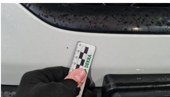
Fot. 39 Zderzak - Rysa/odprysk 1
