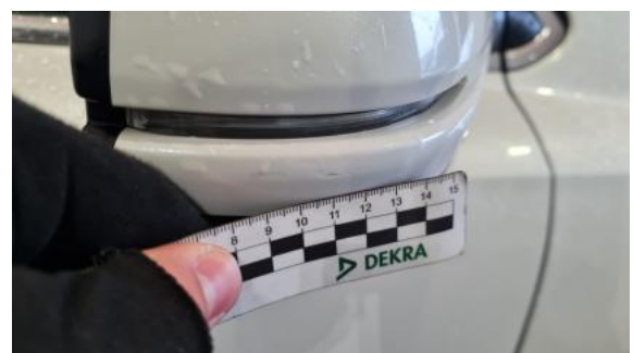
Fot. 40 Lusterko zew P - Rysa/odprysk 1
