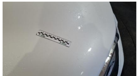
Fot. 38 Pokrywa komory silnika - Rysa/odprysk 2
