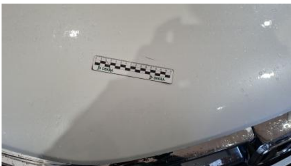
Fot. 37 Pokrywa komory silnika - Rysa/odprysk 1
