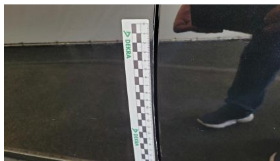
Fot. 46 Drzwi przed L - Rysa/odprysk 1
