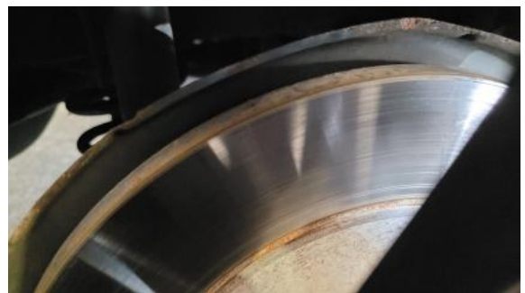
Fot. 30 Tarcza hamulcowa tylna prawa
