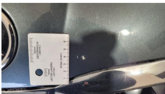
Fot. 31 Pokrywa komory silnika - Rysa/odprysk 1
