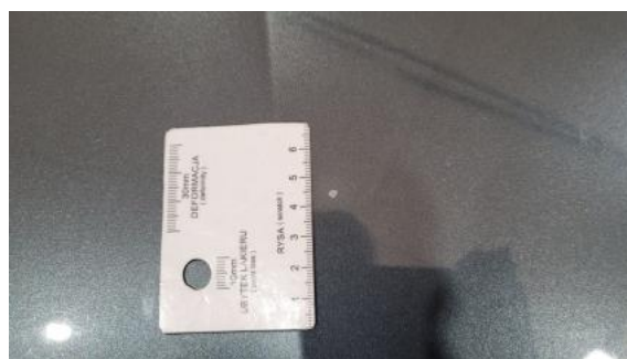
Fot. 32 Pokrywa komory silnika - Rysa/odprysk 2
