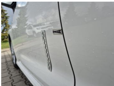
Fot. 35 Drzwi przed L - Wgniecenie/odkształcenie 1
