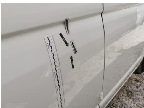
Fot. 39 Drzwi tylne P - Wgniecenie/odkształcenie 1
