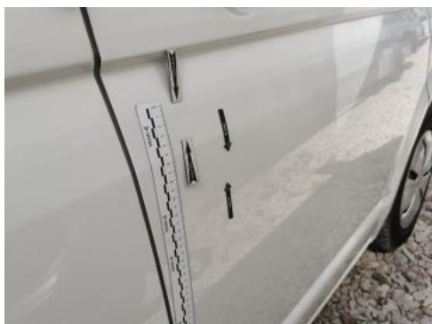
Fot. 37 Drzwi przednie P - Wgniecenie/odkształcenie 1
