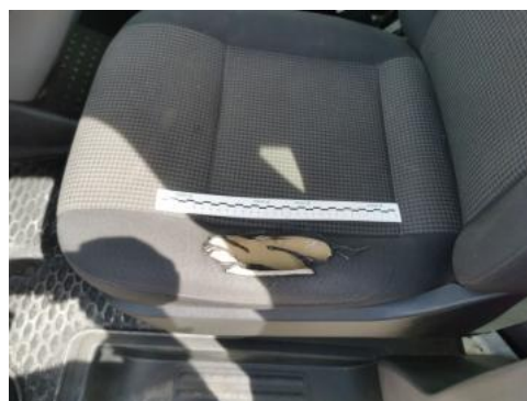
Fot. 44 Fotel prz. lew. - Pęknięcie/rozerwanie 1
