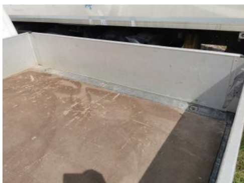
Fot. 47 Ściana prawa - Rysa/odprysk 1
