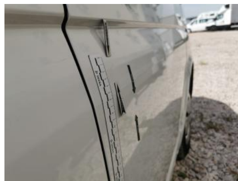
Fot. 38 Drzwi przednie P - Wgniecenie/odkształcenie 2
