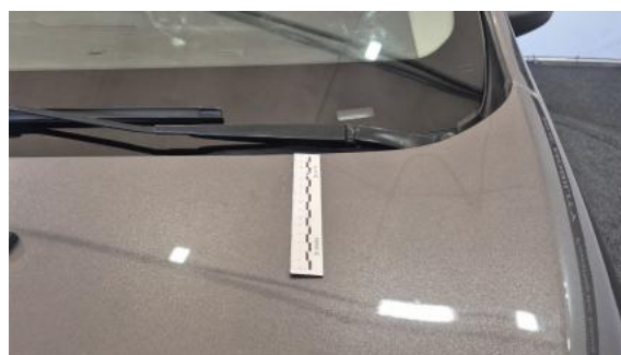
Fot. 32 Pokrywa komory silnika - Rysa/odprysk 1
