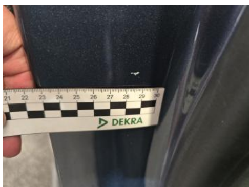
Fot. 43 Próg P() - Rysa/odprysk 3
