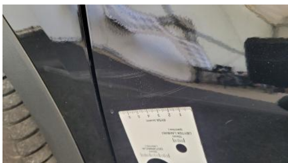
Fot. 37 Drzwi przed L - Rysa/odprysk 2
