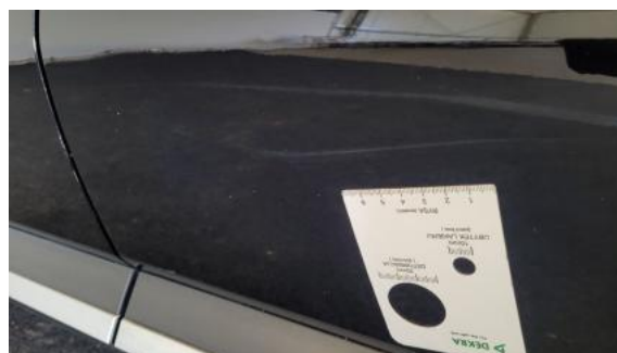
Fot. 38 Drzwi tylne L - Rysa/odprysk 1
