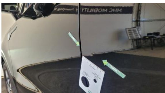
Fot. 39 Drzwi tylne L - Wgniecenie/odkształcenie 1
