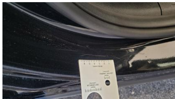
Fot. 34 Próg P - Rysa/odprysk 1
