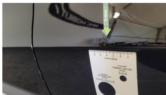
Fot. 40 Drzwi tylne L - Wgniecenie/odkształcenie 2
