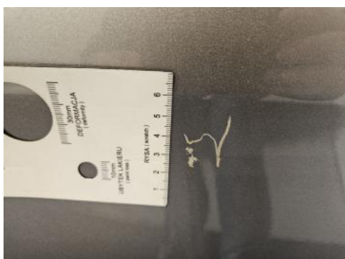
Fot. 45 Błotnik tylny L / Ściana boczna L - Rysa/odprysk 1
