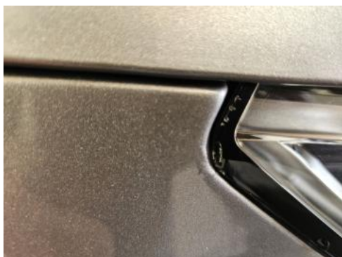
Fot. 41 Reflektor P - Rysa/odprysk 1
