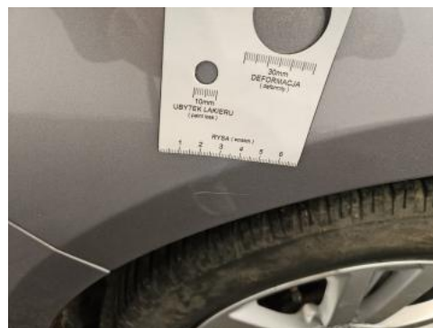
Fot. 42 Błotnik tylny P / Ściana boczna P - Rysa/odprysk 1
