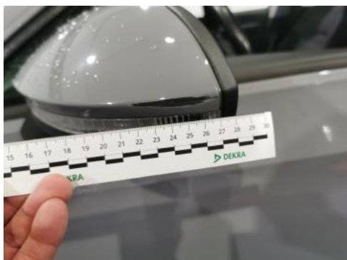
Fot. 49 Lusterko zew L - Rysa/odprysk 1
