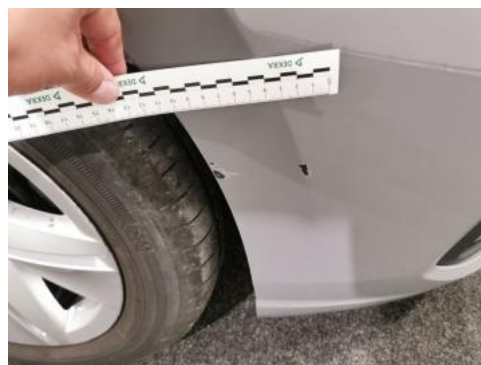
Fot. 42 Zderzak() - Rysa/odprysk 3
