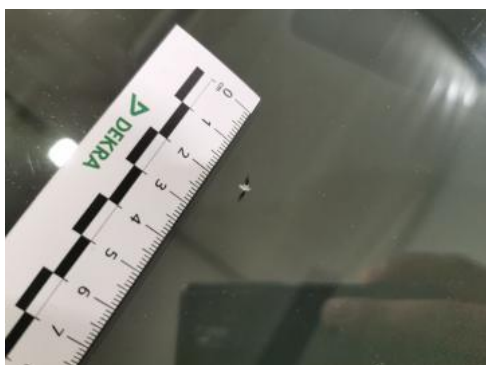
Fot. 39 Szyba czołowa - Pęknięcie/rozerwanie 1
