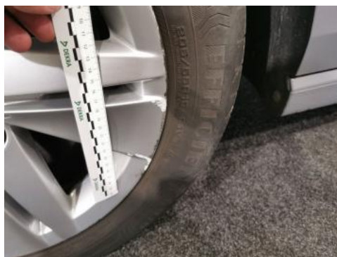
Fot. 50 Felga Aluminiowa przednia L - Rysa/odprysk 1
