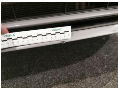
Fot. 41 Zderzak - Rysa/odprysk 2
