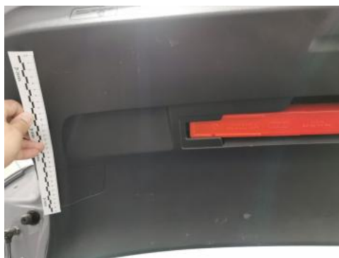
Fot. 54 Wykładzina pokrywy tylnej - Rysa/odprysk 1
