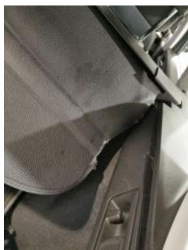
Fot. 53 Półka/roleta tylna - Pęknięcie/rozerwanie 1
