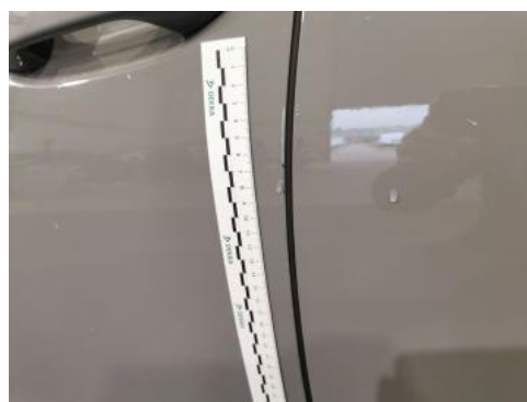
Fot. 46 Drzwi przed L - Rysa/odprysk 1
