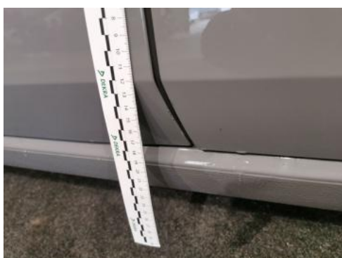
Fot. 47 Drzwi przed L - Rysa/odprysk 2
