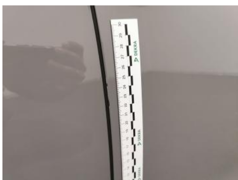
Fot. 43 Drzwi przednie P - Rysa/odprysk 1
