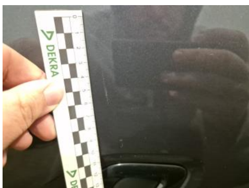
Fot. 45 Błotnik przedni P - Rysa/odprysk 2
