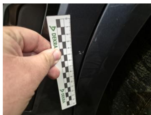
Fot. 44 Błotnik przedni P - Rysa/odprysk 1
