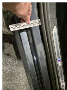
Fot. 46 Próg P - Wgniecenie/odkształcenie 1
