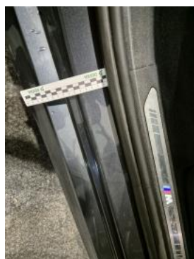
Fot. 47 Próg P - Wgniecenie/odkształcenie 2
