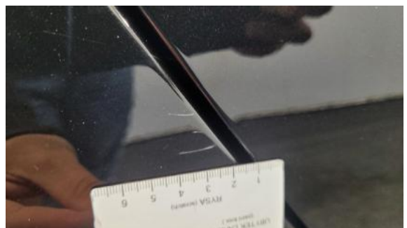
Fot. 44 Błotnik tylny P / Ściana boczna P - Rysa/odprysk 1
