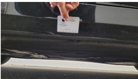
Fot. 43 Próg P - Rysa/odprysk 1
