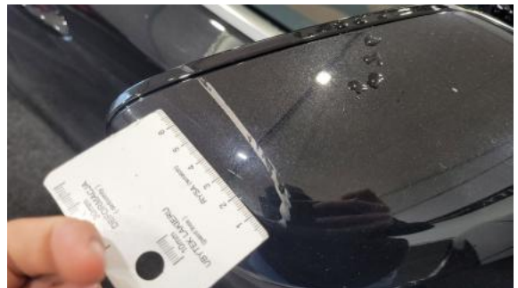
Fot. 42 Obudowa lusterka zew P - Rysa/odprysk 1
