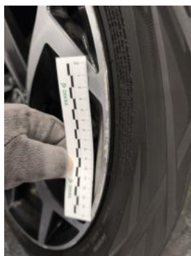
Fot. 41 Felga aluminiowa przednia P - Rysa/odprysk 2
