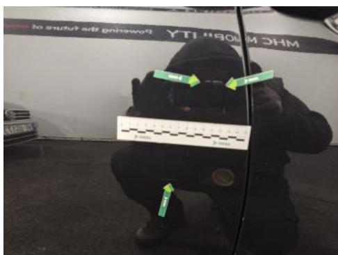
Fot. 43 Drzwi tylne P - Rysa/odprysk 1
