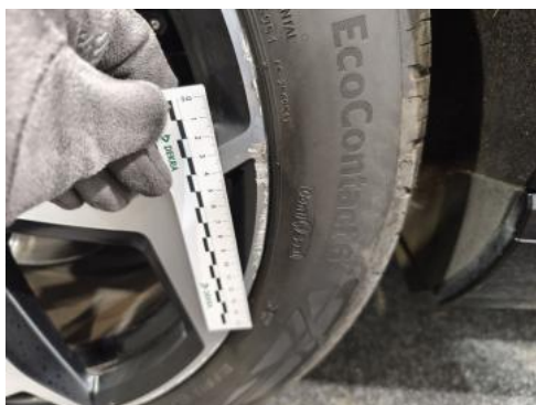
Fot. 45 Felga aluminiowa tylna P - Rysa/odprysk 1
