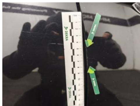
Fot. 42 Drzwi przednie P - Rysa/odprysk 1
