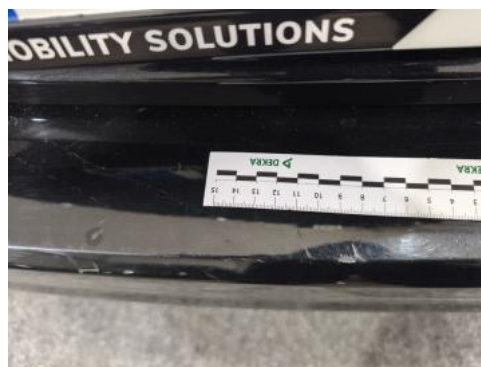
Fot. 48 Zderzak tylny - Rysa/odprysk 1
