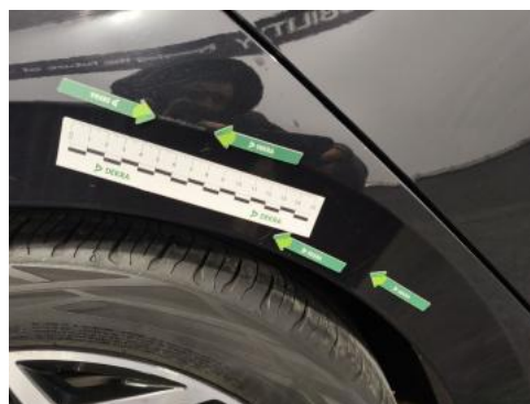
Fot. 44 Błotnik tylny P / Ściana boczna P - Rysa/odprysk 1
