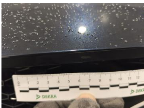
Fot. 35 Zderzak - Rysa/odprysk 1
