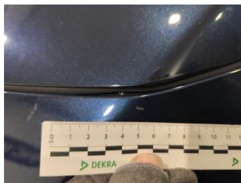
Fot. 36 Zderzak - Rysa/odprysk 2
