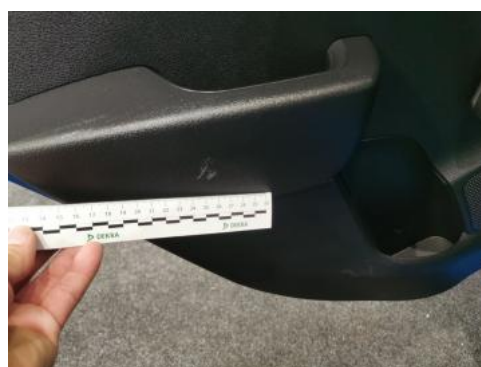
Fot. 52 Tapicerka drzwi tylnych L - Rysa/odprysk 1
