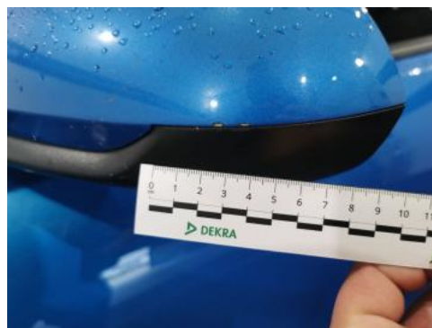
Fot. 50 Lusterko zew L - Rysa/odprysk 1
