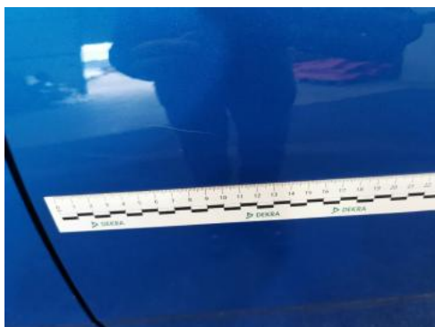
Fot. 49 Drzwi tylne L - Rysa/odprysk 1
