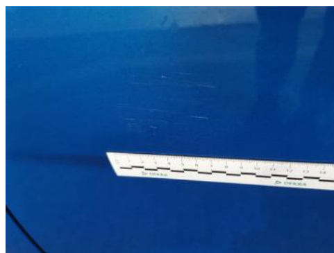
Fot. 48 Drzwi przed L - Rysa/odprysk 1
