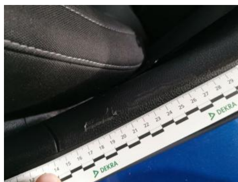
Fot. 54 Wykładzina(y) słupka tylnego L - Rysa/odprysk 1
