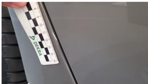
Fot. 34 Błotnik tylny P / Ściana boczna P - Rysa/odprysk 1
