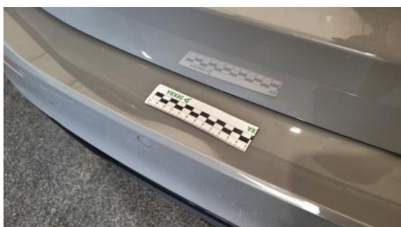
Fot. 39 Zderzak tylny - Wgniecenie/odkształcenie 1
