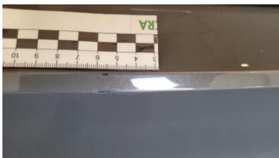
Fot. 37 Zderzak tylny - Rysa/odprysk 1
