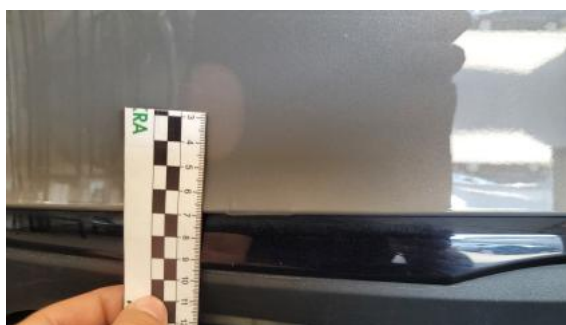
Fot. 40 Zderzak tylny - Wgniecenie/odkształcenie 2
