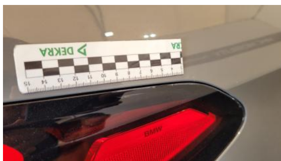
Fot. 36 Lampa tylna zew P - Pęknięcie/rozerwanie 1
