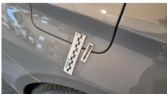
Fot. 35 Błotnik tylny P / Ściana boczna P - Wgniecenie/odkształcenie 1
