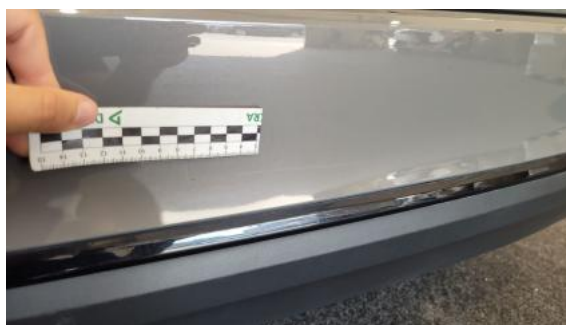
Fot. 38 Zderzak tylny - Rysa/odprysk 2
