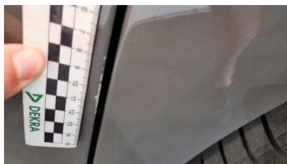
Fot. 44 Drzwi tylne L - Rysa/odprysk 1
