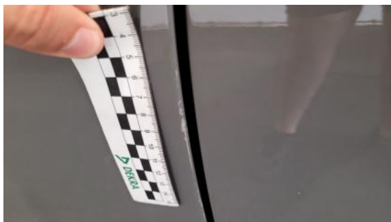
Fot. 41 Drzwi przed L - Rysa/odprysk 1
