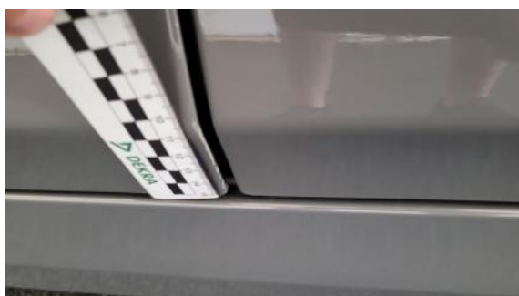
Fot. 43 Drzwi przed L() - Rysa/odprysk 3
