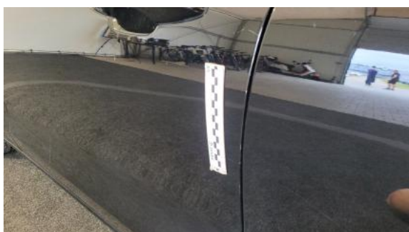
Fot. 43 Drzwi przed L - Rysa/odprysk 1
