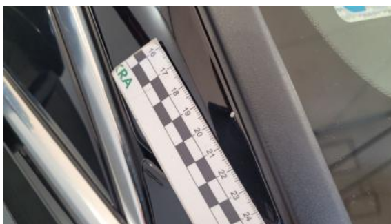
Fot. 39 Śłupek przedni P - Rysa/odprysk 1
