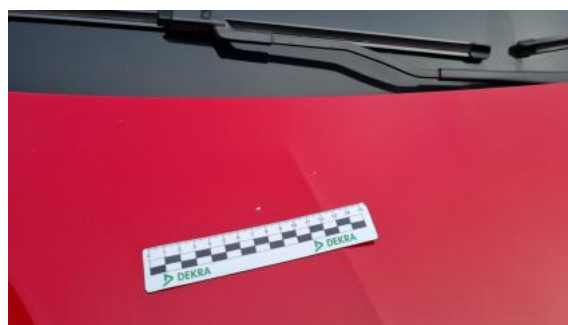
Fot. 32 Pokrywa komory silnika - Rysa/odprysk 2
