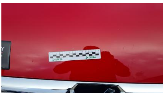
Fot. 31 Pokrywa komory silnika - Rysa/odprysk 1
