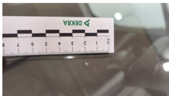
Fot. 32 Szyba czołowa - Pęknięcie/rozerwanie 1
