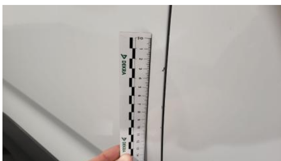
Fot. 35 Drzwi tylne P - Rysa/odprysk 1
