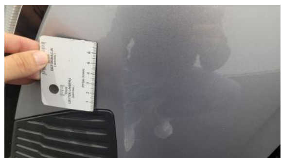
Fot. 32 Zderzak - Rysa/odprysk 1
