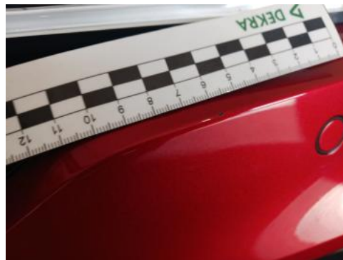
Fot. 42 Zderzak przedni cz L - Rysa/odprysk 1
