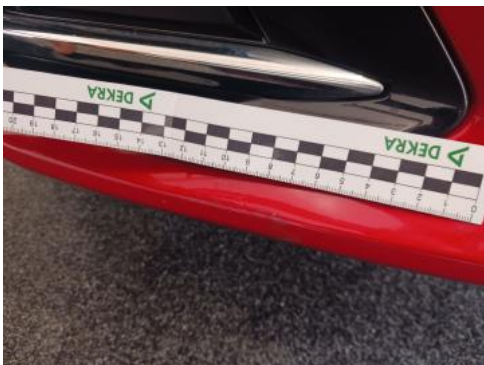
Fot. 41 Zderzak przedni cz dolna - Rysa/odprysk 1
