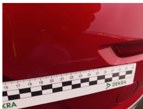
Fot. 54 Zderzak tylny cz śr() - Rysa/odprysk 3
