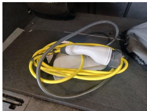
Fot. 28 Przewód ładowania baterii trakcyjnej
