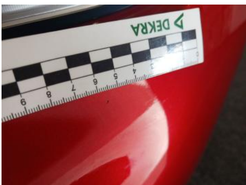
Fot. 43 Zderzak przedni cz L - Rysa/odprysk 2
