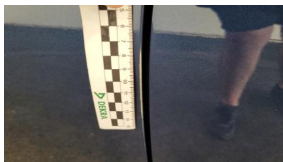
Fot. 48 Drzwi przed L - Rysa/odprysk 1
