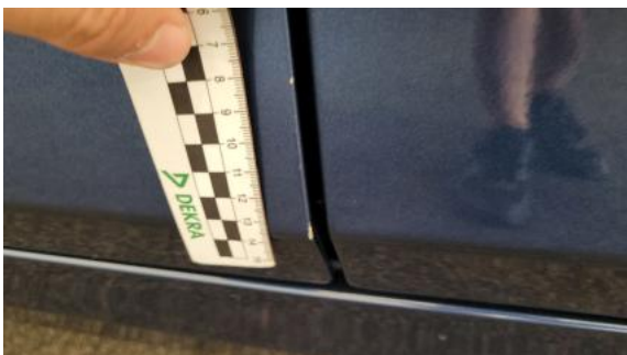
Fot. 49 Drzwi przed L - Rysa/odprysk 2
