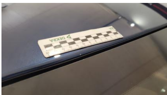
Fot. 47 Dach - Rysa/odprysk 1
