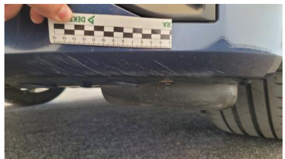
Fot. 36 Zderzak - Rysa/odprysk 1
