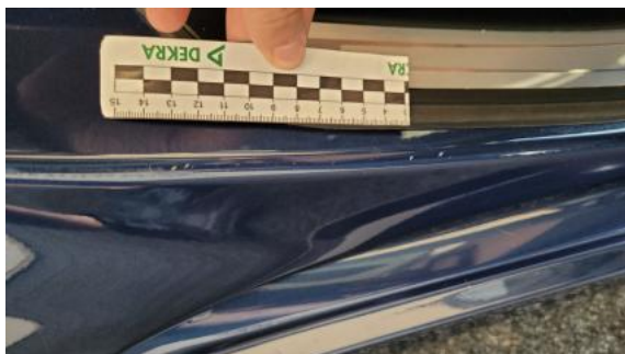
Fot. 41 Próg P - Rysa/odprysk 1
