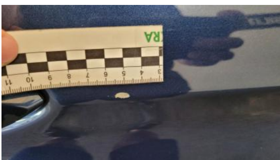
Fot. 39 Drzwi tylne P - Rysa/odprysk 1
