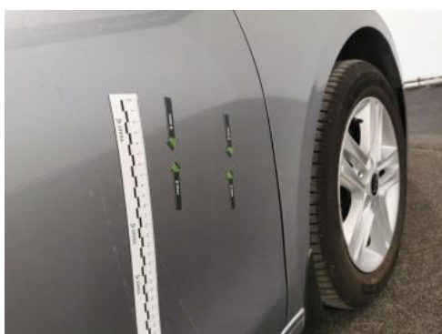
Fot. 39 Drzwi przednie P - Wgniecenie/odkształcenie 1
