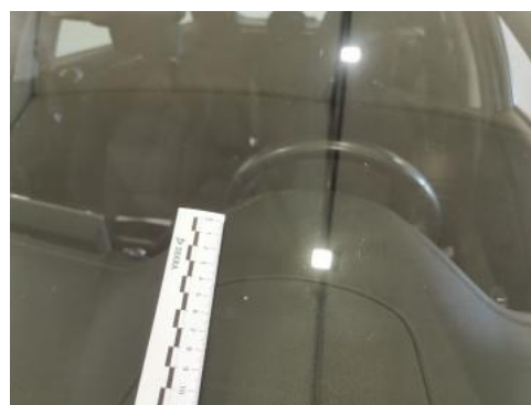
Fot. 38 Szyba czołowa - Rysa/odprysk 1
