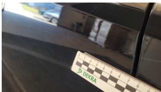
Fot. 38 Drzwi tylne P - Rysa/odprysk 1
