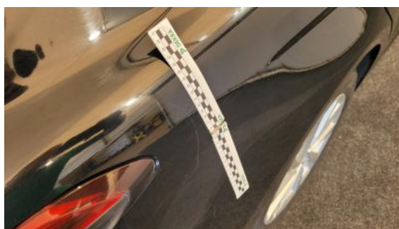
Fot. 40 Błotnik tylny P / Ściana boczna P - Rysa/odprysk 1
