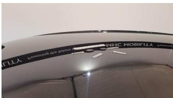
Fot. 43 Dach - Wgniecenie/odkształcenie 1
