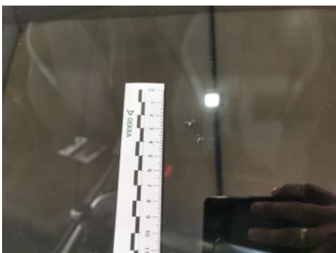
Fot. 37 Szyba czołowa - Pęknięcie/rozerwanie 1
