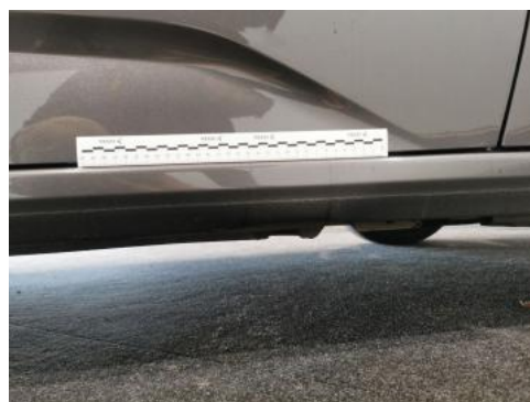
Fot. 40 Próg P - Wgniecenie/odkształcenie 1
