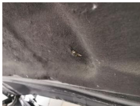
Fot. 38 Wykładzina pokrywy komory silnika - Pęknięcie/rozerwanie 1
