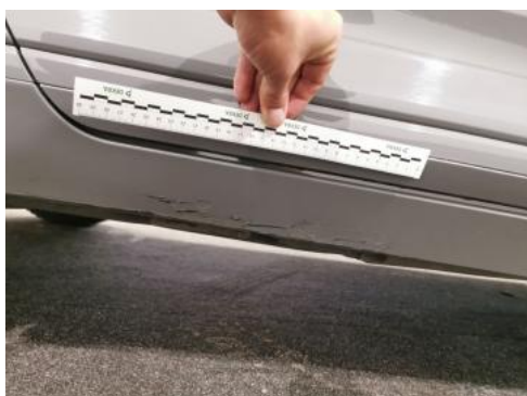
Fot. 43 Próg P - Rysa/odprysk 1
