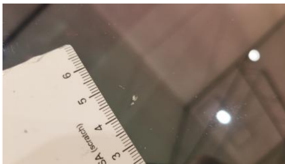
Fot. 37 Szyba czołowa - Rysa/odprysk 1
