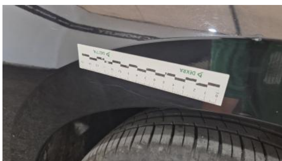
Fot. 43 Błotnik przedni P - Rysa/odprysk 2
