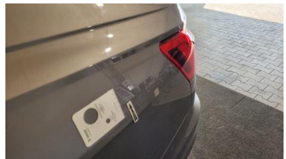
Fot. 46 Błotnik tylny L / Ściana boczna L - Wgniecenie/odkształcenie 1
