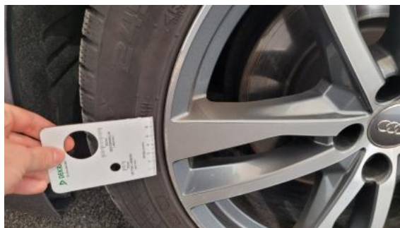
Fot. 50 Felga Aluminiowa przednia L() - Rysa/odprysk 3
