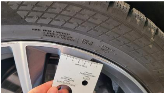
Fot. 41 Felga aluminiowa tylna P - Rysa/odprysk 1
