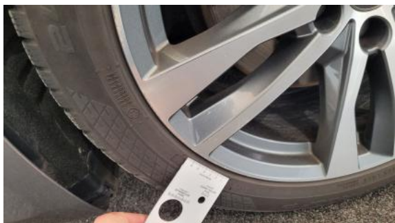
Fot. 49 Felga Aluminiowa przednia L - Rysa/odprysk 2
