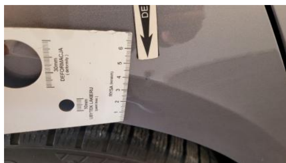
Fot. 40 Błotnik tylny P / Ściana boczna P - Wgniecenie/odkształcenie 1
