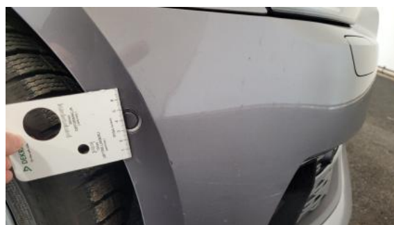
Fot. 36 Zderzak - Rysa/odprysk 1
