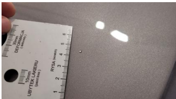
Fot. 33 Pokrywa komory silnika - Rysa/odprysk 1
