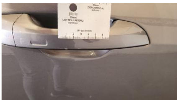
Fot. 39 Klamka drzwi prz P - Rysa/odprysk 1
