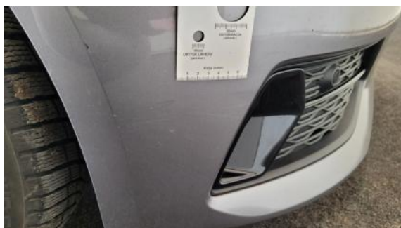
Fot. 37 Zderzak - Rysa/odprysk 2
