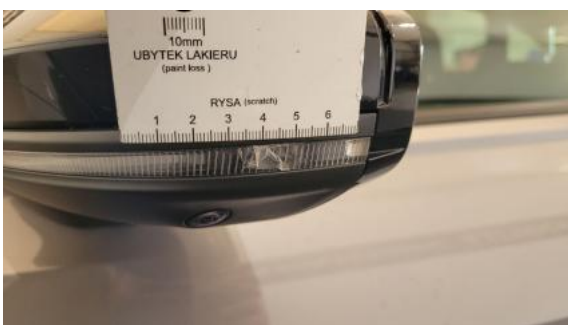
Fot. 47 Kierunkowskaz boczny/lusterka L - Pęknięcie/rozerwanie 1
