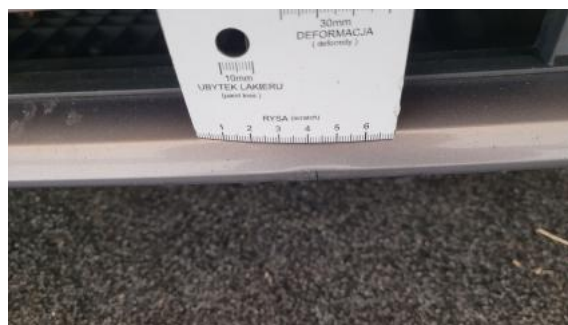
Fot. 38 Zderzak - Wgniecenie/odkształcenie 1
