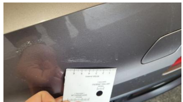
Fot. 44 Zderzak tylny - Rysa/odprysk 2
