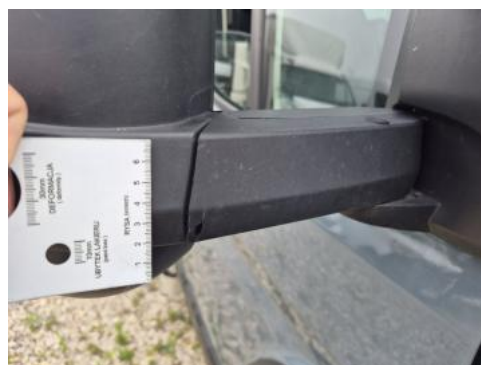
Fot. 40 Lusterko zew P - Pęknięcie/rozerwanie 1
