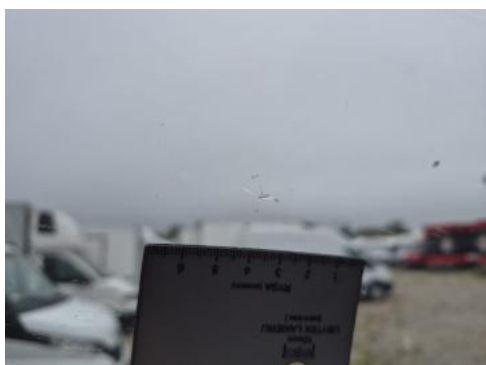
Fot. 39 Szyba czołowa - Pęknięcie/rozerwanie 1
