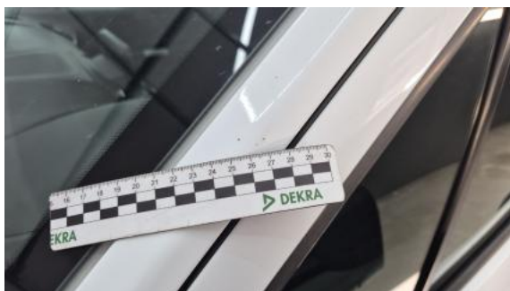
Fot. 53 Słupek przedni L - Rysa/odprysk 1
