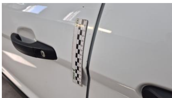
Fot. 44 Drzwi przed L - Rysa/odprysk 1
