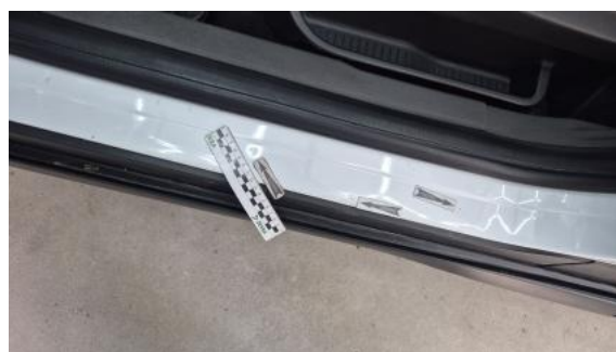
Fot. 52 Próg L - Wgniecenie/odkształcenie 1
