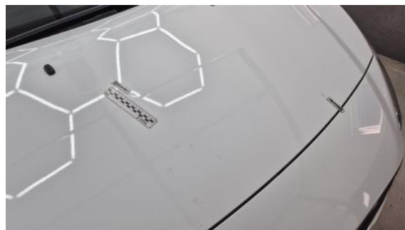
Fot. 34 Pokrywa komory silnika - Wgniecenie/odkształcenie 1
