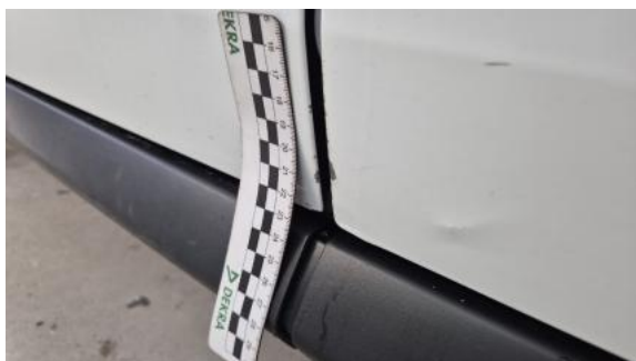
Fot. 45 Drzwi przed L - Rysa/odprysk 2
