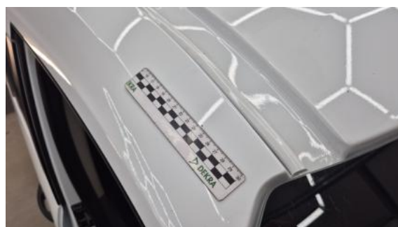
Fot. 40 Słupek przedni P - Rysa/odprysk 1
