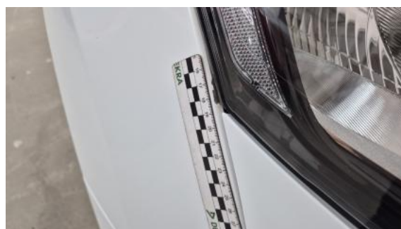
Fot. 36 Błotnik przedni P - Rysa/odprysk 1
