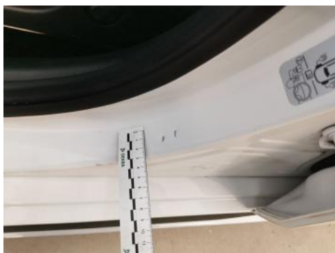
Fot. 57 Słupek środkowy L - Wgniecenie/odkształcenie 1
