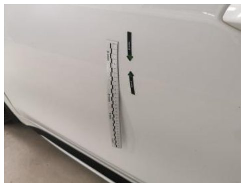
Fot. 54 Drzwi przed L - Wgniecenie/odkształcenie 1
