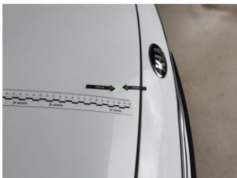
Fot. 41 Pokrywa komory silnika - Wgniecenie/odkształcenie 1
