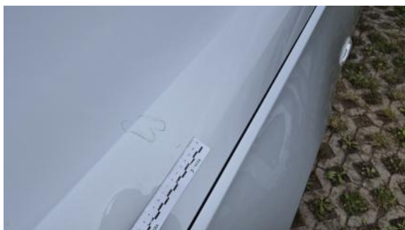
Fot. 37 Pokrywa komory silnika - Rysa/odprysk 1
