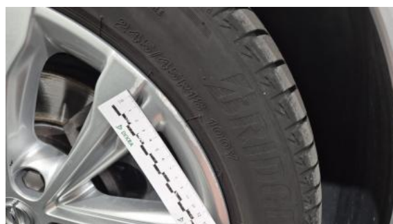
Fot. 40 Felga aluminiowa przednia P - Rysa/odprysk 2
