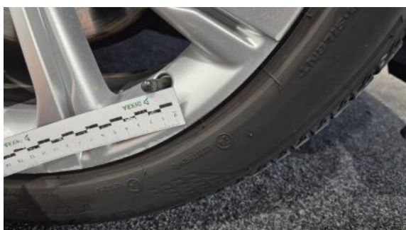
Fot. 39 Felga aluminiowa przednia P - Rysa/odprysk 1
