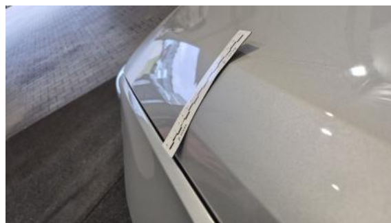
Fot. 38 Pokrywa komory silnika - Wgniecenie/odkształcenie 1
