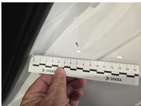
Fot. 49 Próg L - Rysa/odprysk 1
