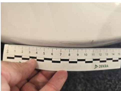
Fot. 39 Zderzak() - Rysa/odprysk 3
