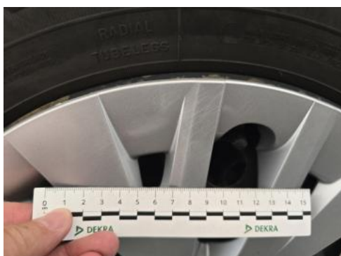
Fot. 45 Kołpak tylny P - Rysa/odprysk 1
