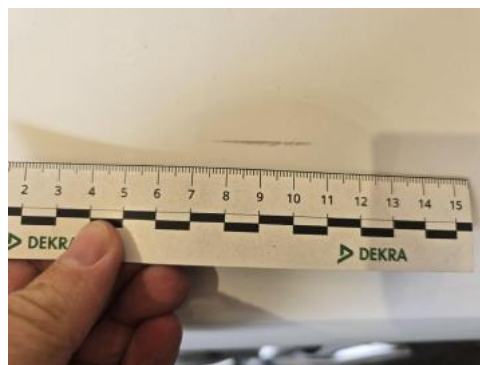
Fot. 50 Błotnik przedni L - Rysa/odprysk 1
