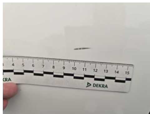
Fot. 42 Drzwi tylne P - Rysa/odprysk 1
