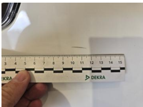
Fot. 51 Błotnik przedni L() - Rysa/odprysk 3
