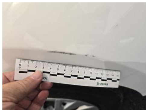
Fot. 38 Zderzak - Rysa/odprysk 1
