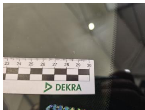
Fot. 40 Szyba czołowa - Rysa/odprysk 1
