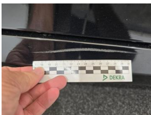
Fot. 55 Próg P - Rysa/odprysk 1
