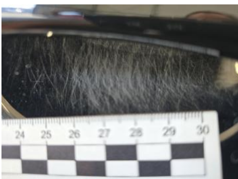
Fot. 75 Drzwi przed L() - Rysa/odprysk 3
