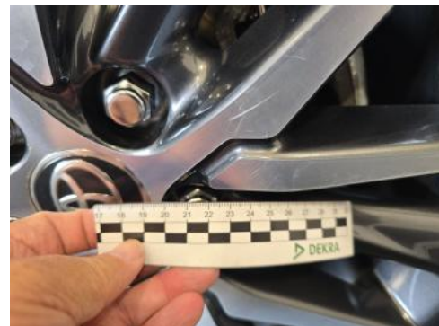
Fot. 70 Felga aluminiowa tylna L - Rysa/odprysk 1
