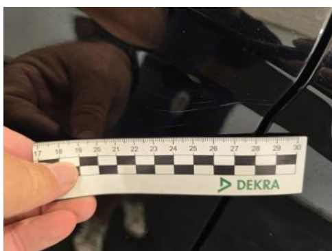
Fot. 53 Drzwi tylne P - Rysa/odprysk 2
