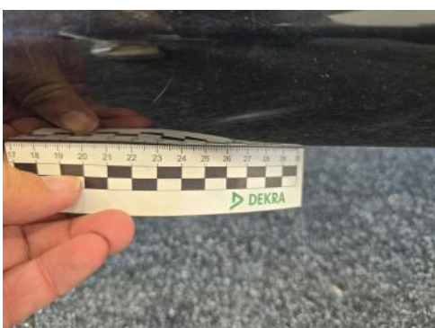
Fot. 79 Próg L - Rysa/odprysk 1
