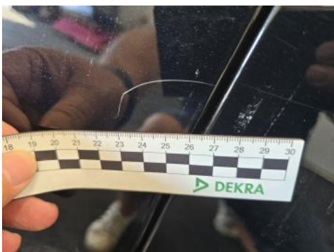
Fot. 73 Drzwi przed L - Rysa/odprysk 1
