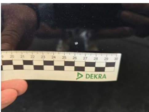
Fot. 77 Drzwi tylne L - Rysa/odprysk 2
