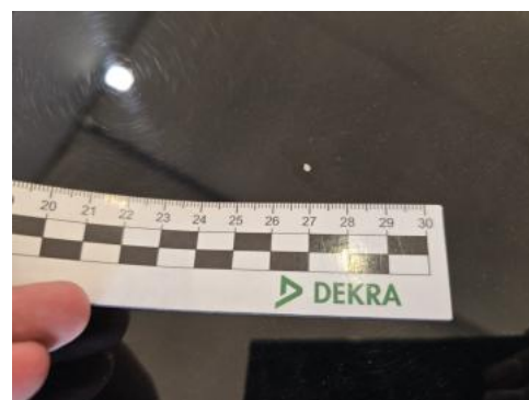
Fot. 38 Pokrywa komory silnika - Rysa/odprysk 1
