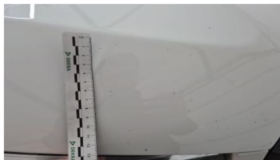
Fot. 38 Pokrywa komory silnika - Rysa/odprysk 2
