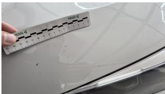
Fot. 37 Pokrywa komory silnika - Rysa/odprysk 1
