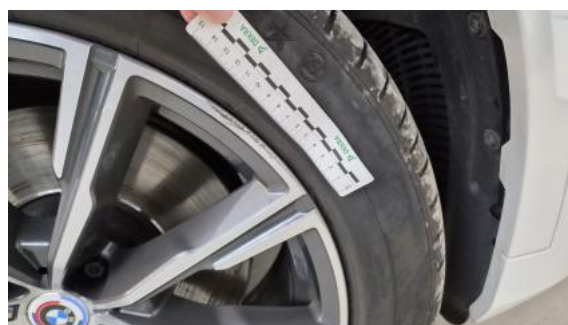
Fot. 40 Felga aluminiowa przednia P - Rysa/odprysk 1
