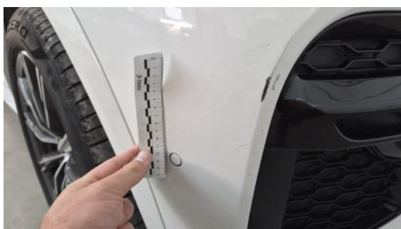
Fot. 39 Zderzak - Rysa/odprysk 1
