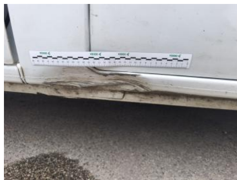
Fot. 38 Próg P - Wgniecenie/odkształcenie 1
