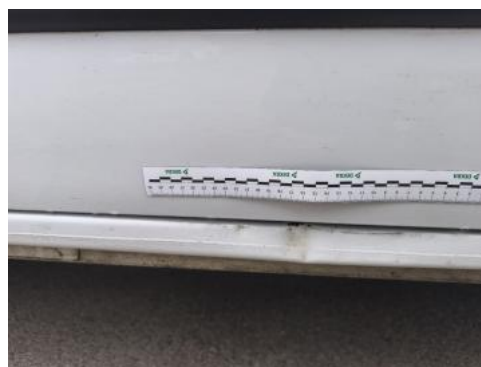
Fot. 40 Próg P() - Wgniecenie/odkształcenie 3
