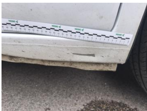
Fot. 39 Próg P - Wgniecenie/odkształcenie 2
