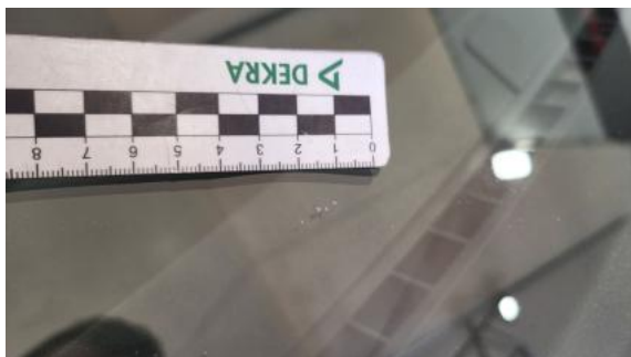
Fot. 33 Szyba czołowa - Rysa/odprysk 1
