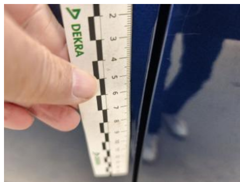
Fot. 58 Drzwi przed L() - Rysa/odprysk 3
