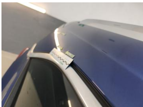
Fot. 49 Błotnik tylny P / Ściana boczna P() - Wgniecenie/odkształcenie 3
