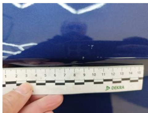
Fot. 54 Błotnik tylny L / Ściana boczna L - Rysa/odprysk 1
