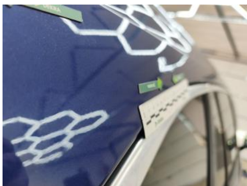
Fot. 47 Błotnik tylny P / Ściana boczna P - Wgniecenie/odkształcenie 1
