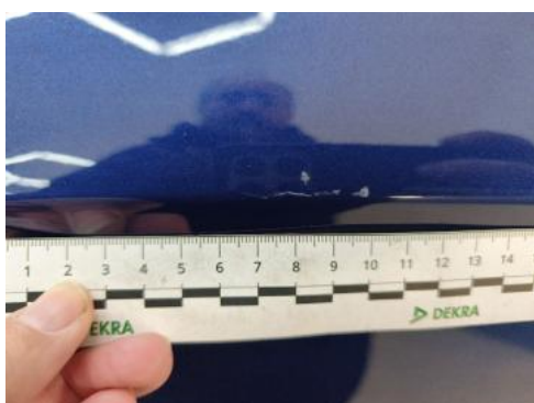
Fot. 55 Błotnik tylny L / Ściana boczna L() - Rysa/odprysk 3
