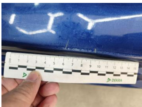
Fot. 61 Próg L() - Rysa/odprysk 3
