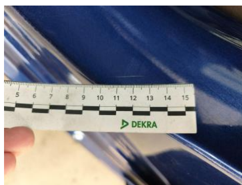
Fot. 60 Próg L - Rysa/odprysk 1
