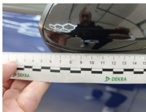
Fot. 44 Obudowa lusterka zew P - Rysa/odprysk 1
