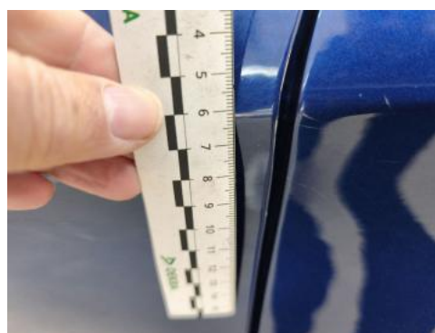
Fot. 56 Drzwi przed L - Rysa/odprysk 1
