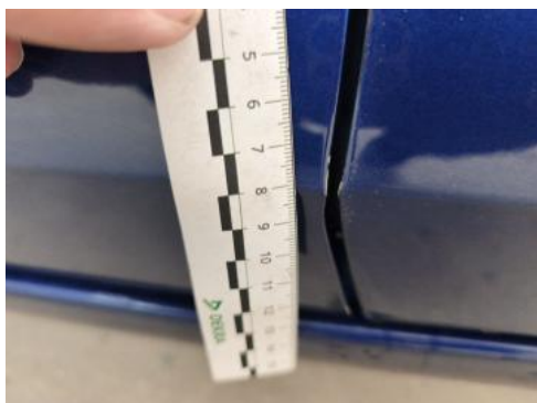
Fot. 57 Drzwi przed L - Rysa/odprysk 2
