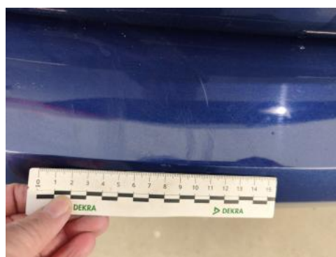
Fot. 52 Zderzak tylny - Rysa/odprysk 2
