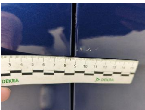
Fot. 39 Drzwi przednie P - Rysa/odprysk 1
