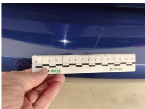
Fot. 53 Zderzak tylny() - Rysa/odprysk 3
