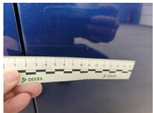
Fot. 40 Drzwi przednie P() - Rysa/odprysk 3
